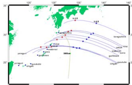
図6 各GPS局で3番衛星を使って観測できる電離層(300km)の位置とロケットの軌道
