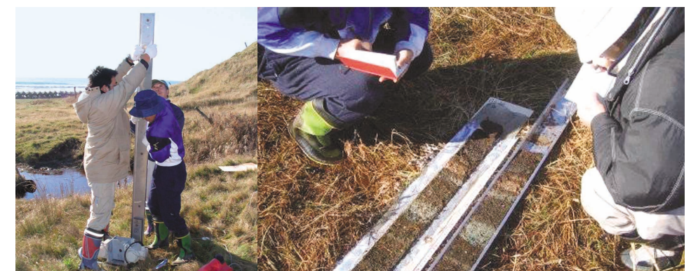
図5 ハンディ・ジオスライサーによる津波堆積物調査。北海道根室市別当の泥炭地にて。
